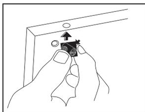
Убедитесь, что винт должным образом затянут через боковину в дюбель. Чтобы не повредить резьбу, используйте две отвертки, одной направляйте дюбель, второй — закручивайте винт в дюбель.
